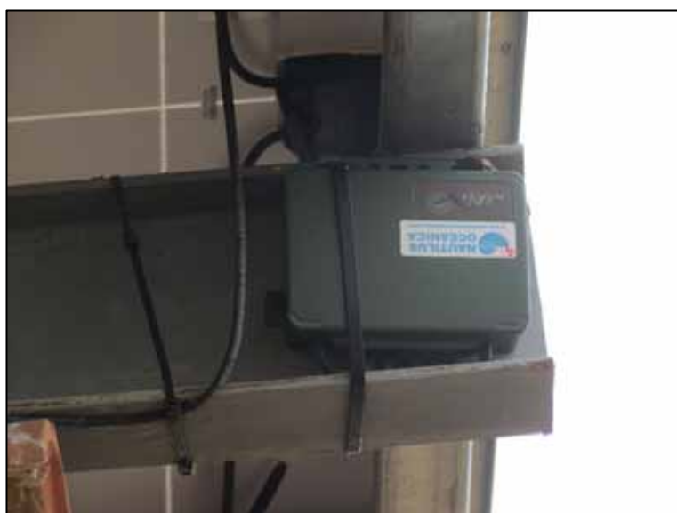
Figura 15. Caseta de bombeo sobre la que se ha instalado el detector/grabador pasivo Song Meter SM4bat. Detalles de la colocación del mismo.
