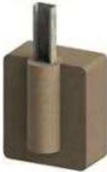
Imagen-croquis de cimentación con preperforación
