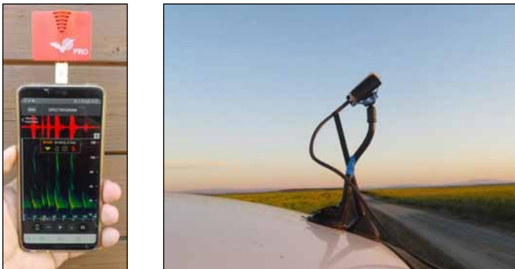
Figura 14. Izquierda, Detector Echo Meter Touch 2 PRO conectado directamente a móvil Android; Derecha, Detector instalado sobre el techo del vehículo y conectado por cable 3 m al mismo móvil.
