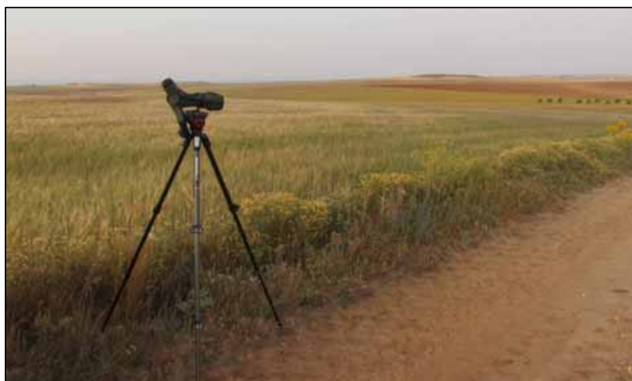
Figura 5. Telescopio terrestre Swarovski 25-60x65 instalado sobre su trípode en uno de los itinerarios de censo.
